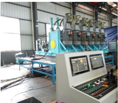
自升自航式工程船桩腿升降电液控制系统
